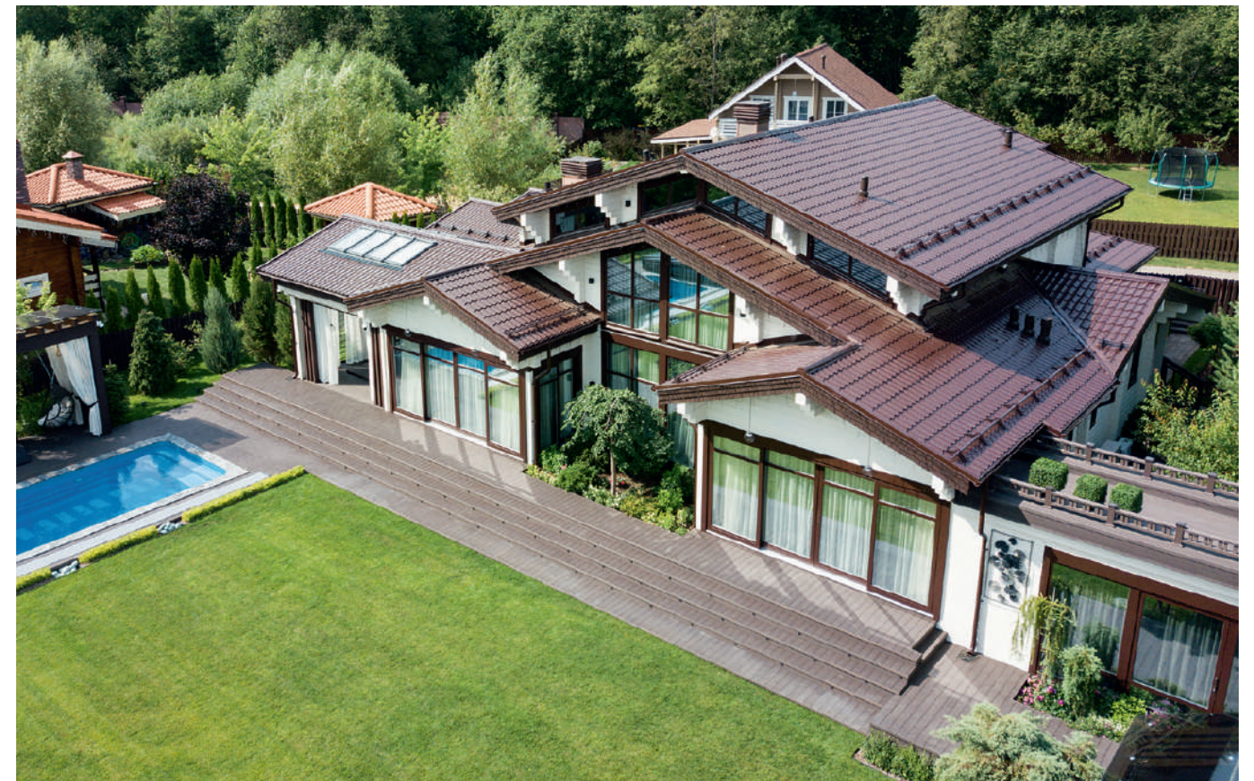
Металлочерепица Классик в покрытии PurPro, RAL 8017
