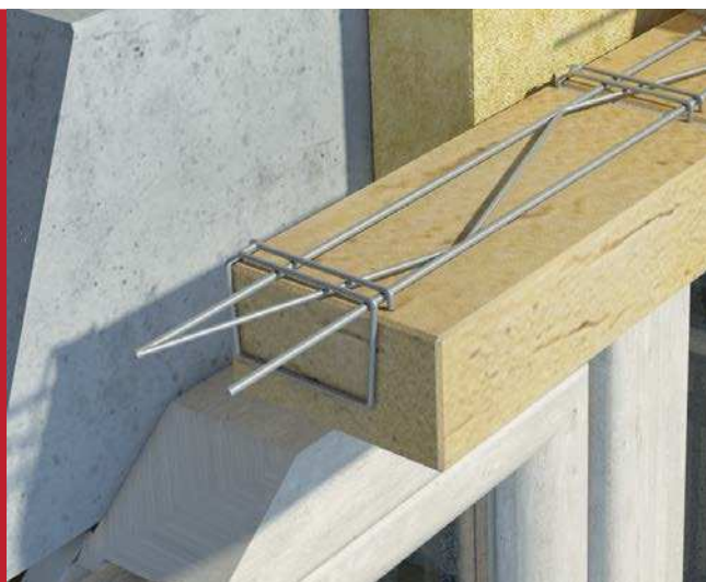
ЗАКЛАДНОЙ КАРКАС MURFOR®
