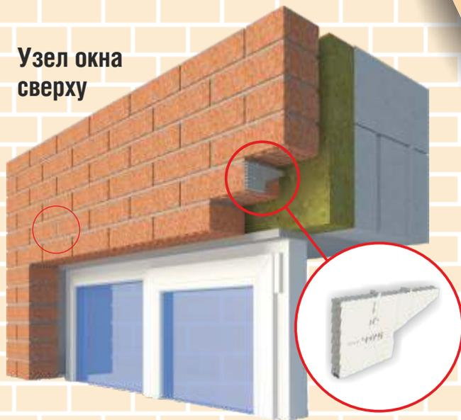
**Устройство вентиляционной коробочки Ventek**
