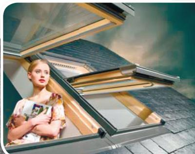
Окно preSelect сочетает в себе два способа открывания: среднеповоротное (позволяет вращать оконную створку на угол до 180°, что значительно облегчает мытье внешнего стекла) и подвесное (по верхней оси от 0° до 35°). Эксклюзивная фурнитура гарантирует надежную фиксацию створки при любом способе открывания. В окне preSelect предусмотрена простая и удобная система переключения режимов открывания. Переключатель находится на боковом элементе оконной коробки и незаметен при закрытом окне.
