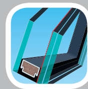
Стеклопакет L3: внешнее стекло – закаленное с легкоочищаемым покрытием, внутреннее стекло – ламинированное (ударостойкая система «триплекс»), теплая дистанционная рамка TGI
