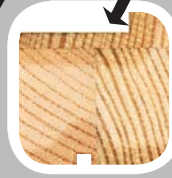
Древесина сосны высшего сорта без сучков, клееная слоями и пропитанная антисептиком
