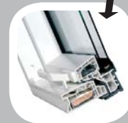
Многокамерный профиль ПВХ белого цвета, усиленный оцинкованными стальными профилями
