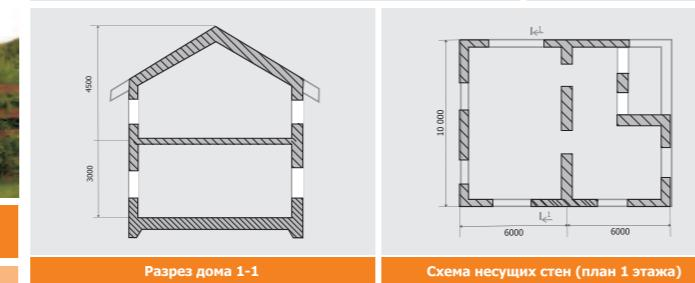
**Уменьшение толщины стен с 375 мм до 300 мм позволит сэкономить 11 куб. м блоков AEROC; Увеличить полезную площадь помещений на 8 кв. м; Снизить себестоимость возведения стен на 30%.**
