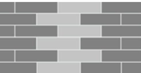
Läuferverband Alle Schichten bestehen aus Läufern, die von Schicht zu Schicht um \frac{1}{2} Stein (= mittlerer Verband) oder um \frac{1}{4} Stein (= schleppender Verband) versetzt sind.
