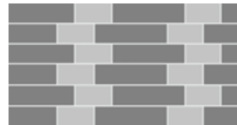
Gotischer Verband Läufer und Köpfe wechseln innerhalb einer Schicht regelmäßig ab. Die Stoßfugen jeder zweiten Schicht liegen übereinander; dazwischen sind sie jeweils um \frac{1}{2} Kopfbreite versetzt.
