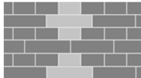
Kreuzverband Ähnlich wie beim Blockverband wechseln die Kopf- und Läufer-schichten. Die Stoßfugen jeder zweiten Läufer-schicht sind um \frac{1}{2} Steinlänge versetzt. Daraus ergibt sich das charakteristische „Kreuz-Bild“.
