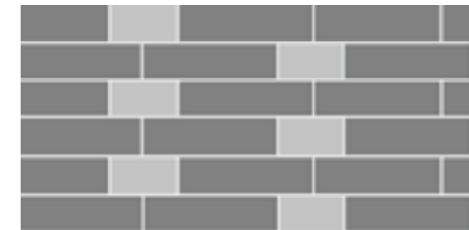
Märkischer Verband Je zwei Läufer und ein Kopf wechseln Schicht für Schicht regelmäßig ab, wobei die Stoßfugen jeder zweiten Schicht übereinander liegen.
